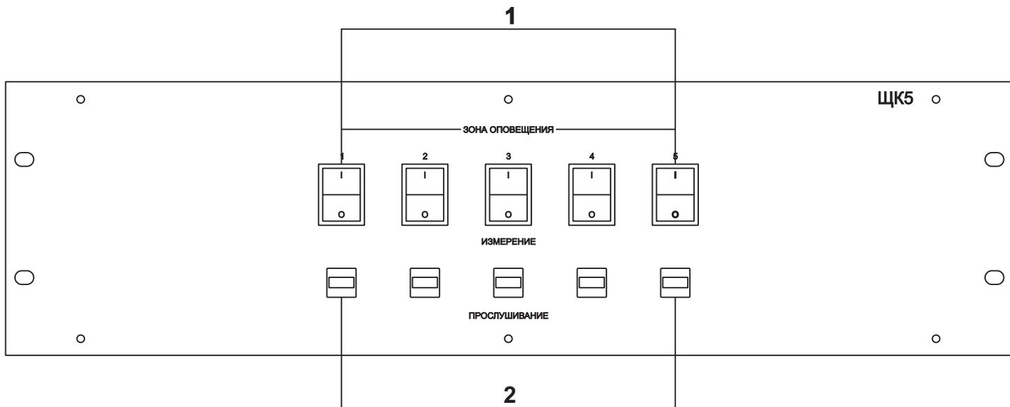
1. ВКЛЮЧАТЕЛЬ ЗОН ОПОВЕЩЕНИЯ С ИНДИКАЦИЕЙ ВКЛЮЧЕНИЯ
