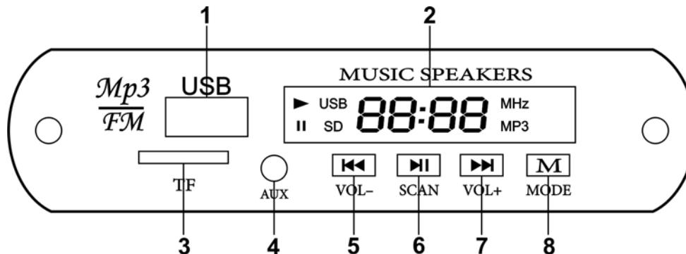
**1** Слот для подключения USB устройств
